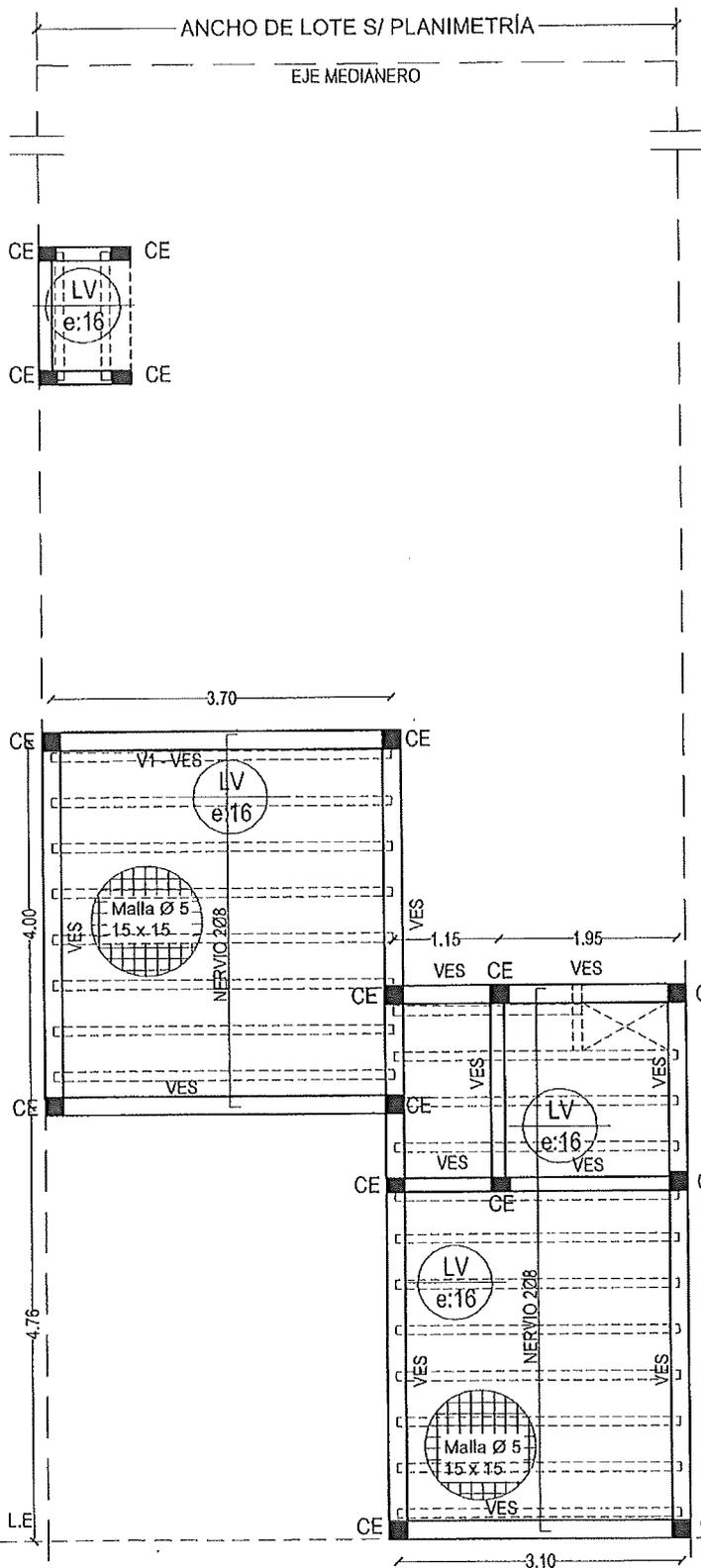
Planta Estructura de Losa
